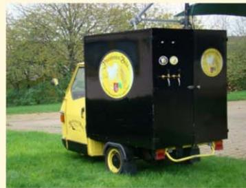
**APE-Dreirad mit integrierter Zapfanlage
